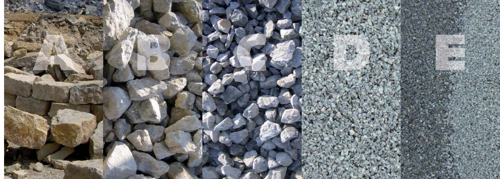
A. Flussbausteine, B. Schroppenmaterial, C. Grober Schotter, D. Schotter/Splitte, E. Feine Splitte
